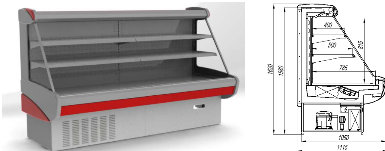
Рисунок 2. Внешний вид и сечение витрины «ИЗУМРУД-А»
