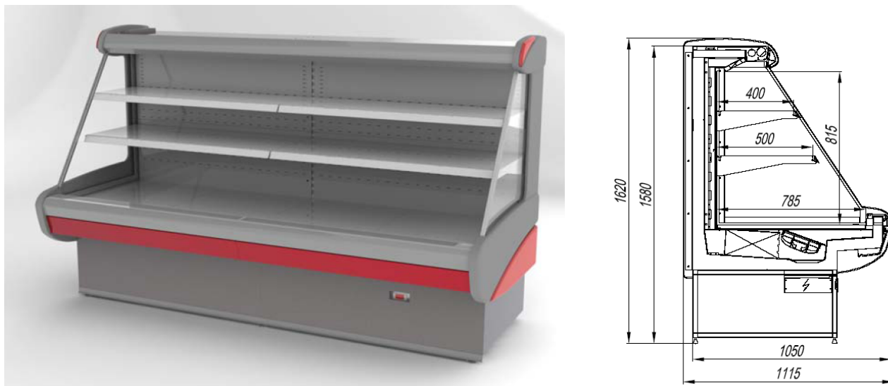
Рисунок 1. Внешний вид и сечение витрины «ИЗУМРУД»
