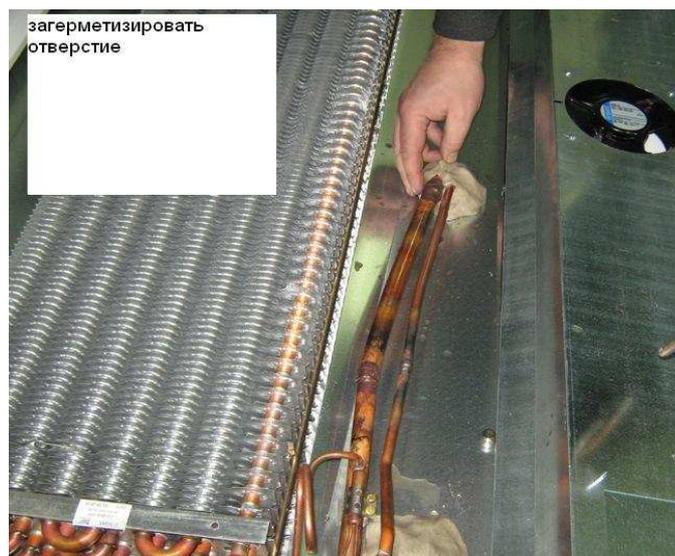
5. Положение коллектора и трубок после пайки (фото 6).
