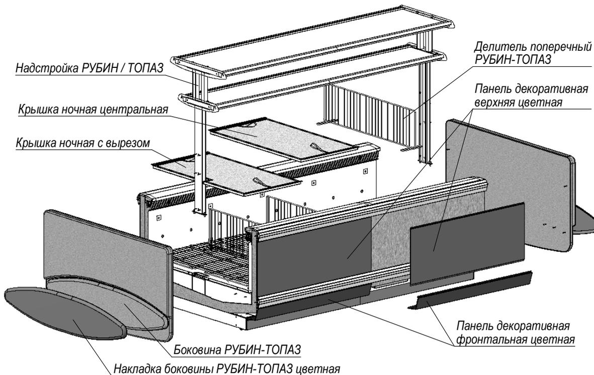
**Рис.2 Общий вид витрины ТОПАЗ**
