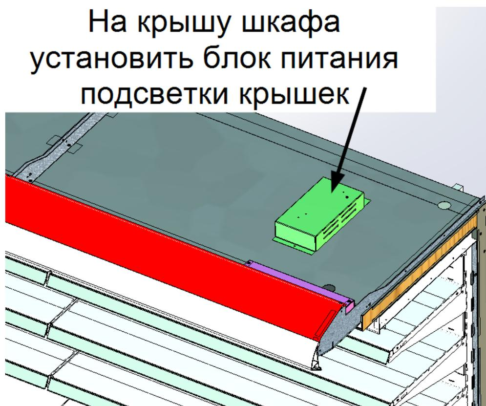
7) Вставить провода в разъём и подключить его к блоку питания на крыше.
