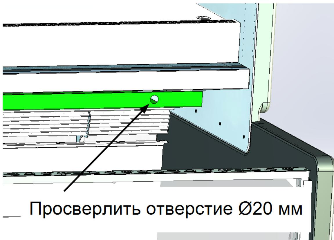
2) Сделать отверстие в пенопласте (с помощью трубки Ø19 во вложении).
